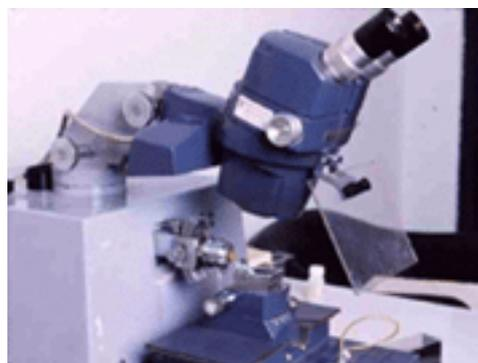
Ilustración 36. Microscopio de efecto túnel
