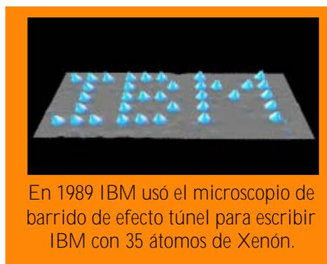
En 1989 IBM usó el microscopio de barrido de efecto túnel para escribir IBM con 35 átomos de Xenón.
